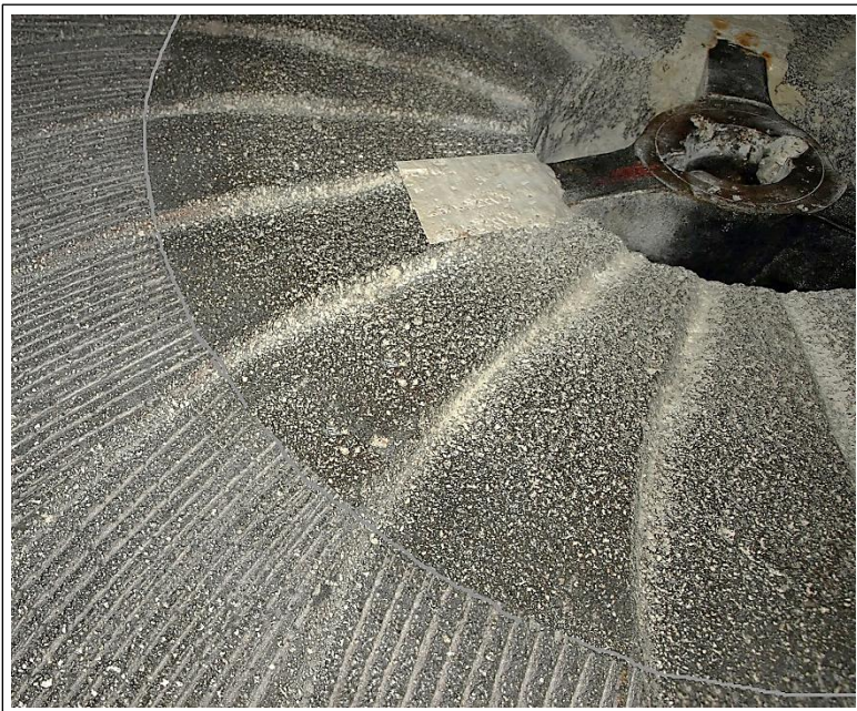
Darstellung der Luftfurchen und der Bereich Schluck und Mahlfläche
